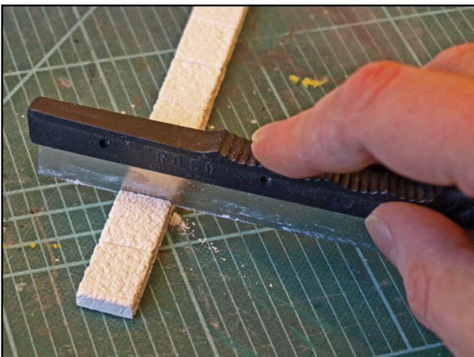
Mit einer Rocosäge können die Decksteinreihen leicht gekürzt werden.
