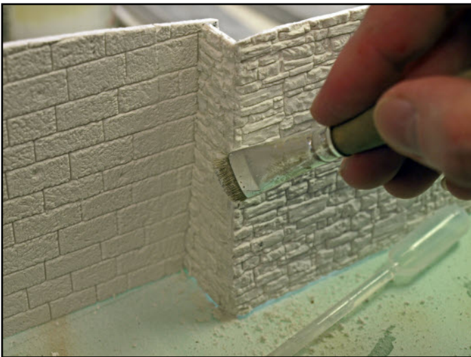
Der überflüssige Gips wird durch den Wasserentzug des Gipsmaterials bröselig und kann leicht abgebürstet werden.
